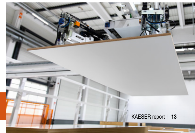
Los transportadores que levantan las piezas grandes necesitan aire comprimido para funcionar (principio de Venturi).
